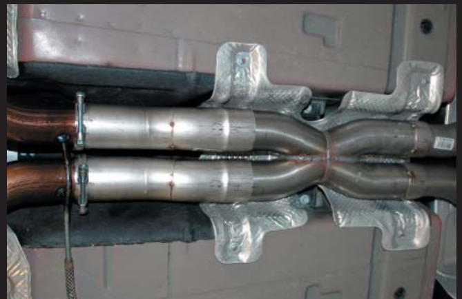
Bild 6. Ett X-pipe jämnar ut pulserna!
