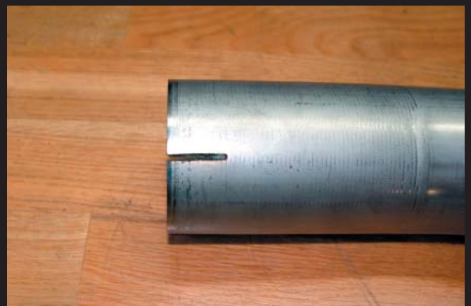
Bild 3. Egen slits gjord med vinkelslip.
